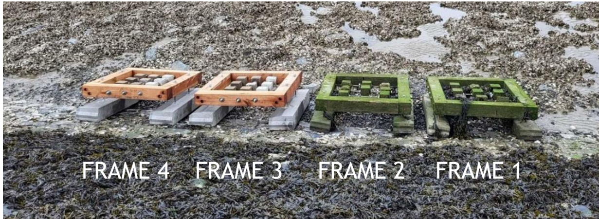
Figuur 33 Schematisatie van de proefopstelling ecologie bestaande uit vier onderzoeksframes
