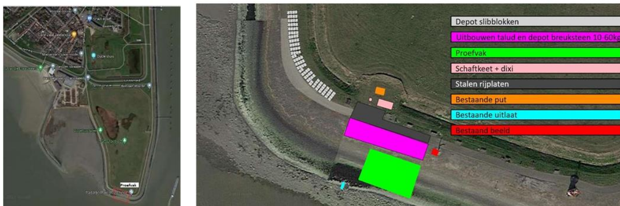
Figuur 49 Een luchtfoto met de projectlocatie (I) en inrichting van de bouwplaats t.b.v. proefvak
