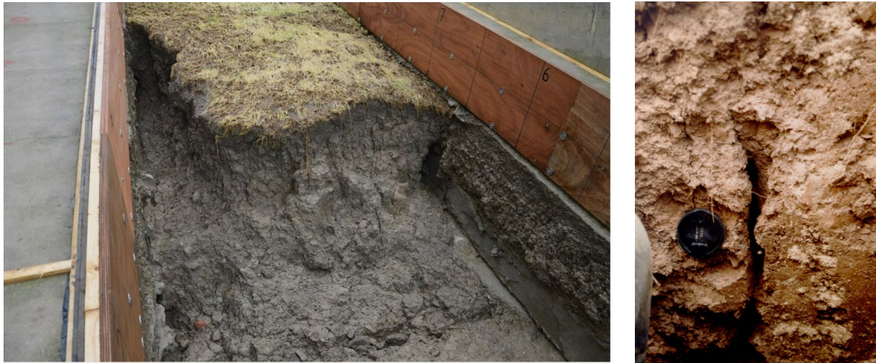
Foto 3 Voorbeelden van structuur in kleibekleding van dijken te zien. De foto links is van Blija klei in Deltagoot (links [64]) en kleibekleding van de Kandiadijk (rechts, foto G.A.M. Kruse, 1981)
